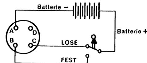
Nennspannungs-Bereich von 24 - 72 V
